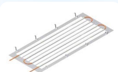
Système de plafond rafraîchissant par contact Placoplâtre-Bois
