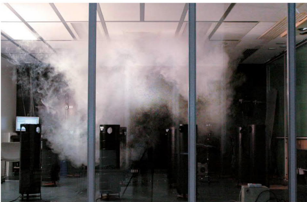
Figure 6: Mode chauffage continu, température de l'air pulsé comprise entre 22 et 26 °C
