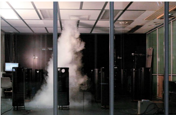
Figure 7: Mode mise en température, température de l'air pulsé comprise entre 27 et 30 °C
