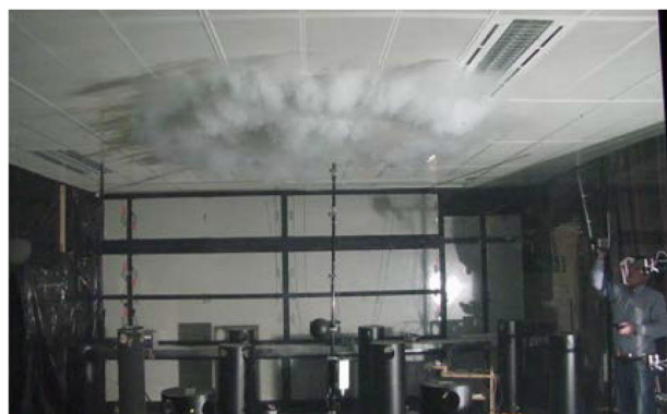
Figure 2: Schéma de diffusion visualisé par de la fumée
