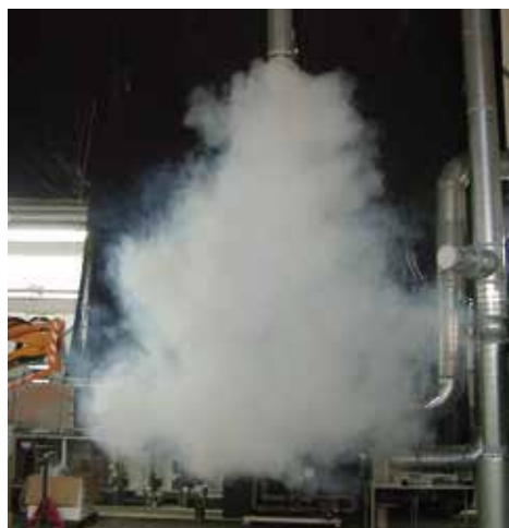
Figure 3: Diffusion de l'air en mode refroidissement et en mode chauffage mis en évidence par un test de fumée
