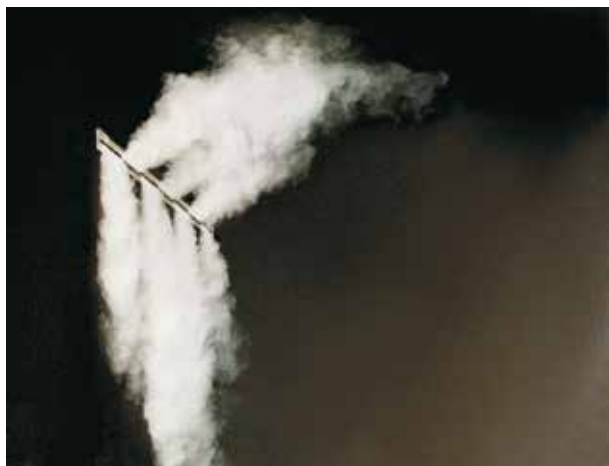
Figure 4: Propagation de l'air mise en évidence par un test de fumée Ci-dessus: en biais vers le haut ainsi que vers le bas A droite: à l'horizontale
