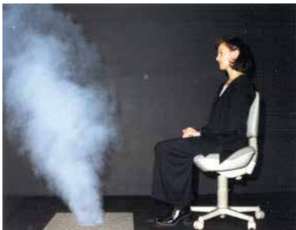
Figure 3: Direction du jet pour différents réglages, représentée pour la grandeur DN 200
