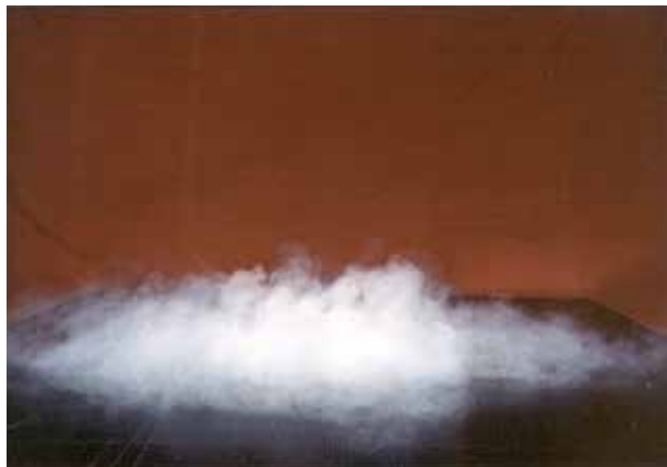
Figure 4: Propagation radiale horizontale à faible turbulence du jet, visualisée par un essai de fumée.
