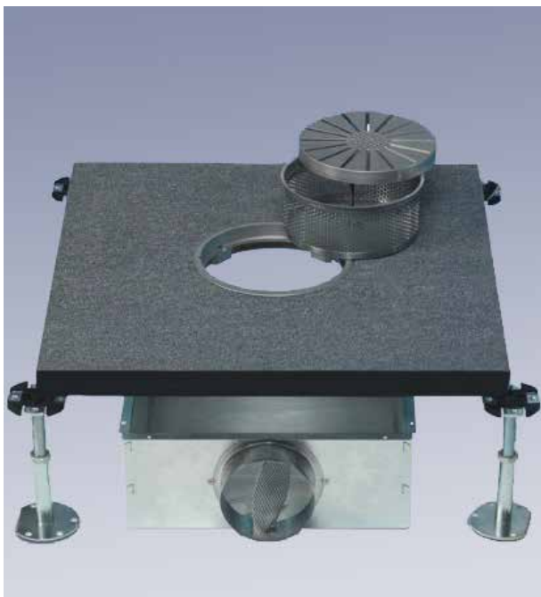
Figure 7: Diffuseur de sol à déplacement d'air Q-B-DN 200. Exemple de montage: panier de répartition „exécution en tôle perforée“ VPD avec dispositif de clapet, ainsi que panneau de plancher à garniture de serrage dans un trou traversant; en dessous caisson de raccordement avec tubulure.
