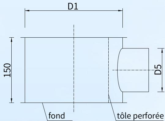
pour montage direct sous le panneau du faux-plancher
