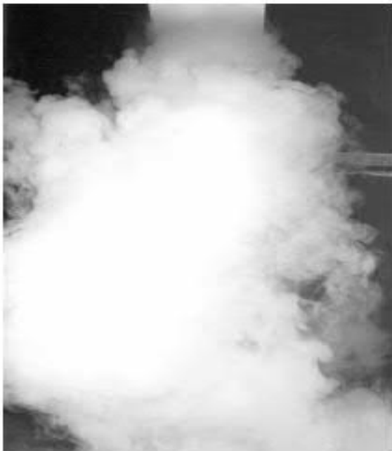
Diffusion du jet visualisée par un essai de fumée, cas de refroidissement
