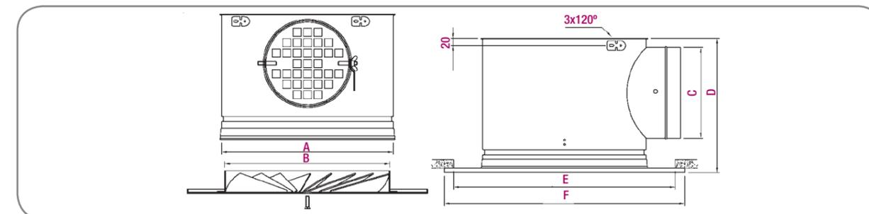
Possibilité de fabrication d'un plénum sur mesure en fonction de la hauteur disponible dans le faux plafond.
