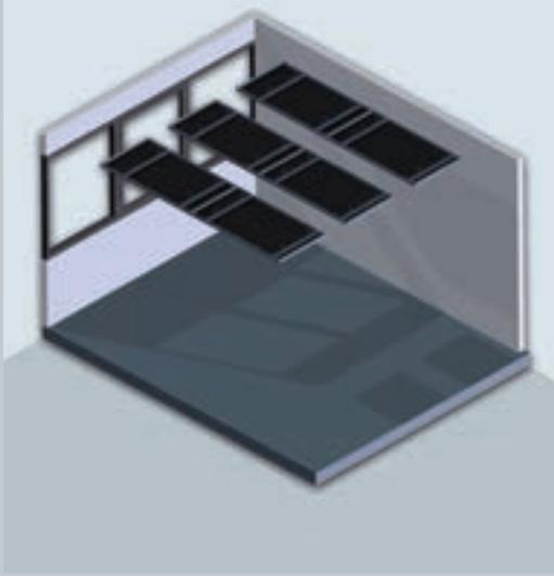
Exemple de configuration de panneaux acoustiques
