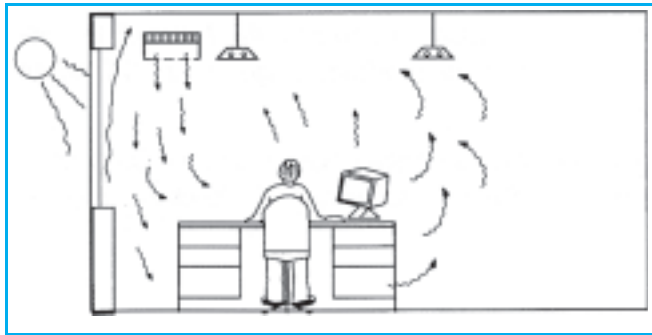
Bild 9: Deckenkühlkonvektor an der Fassade
