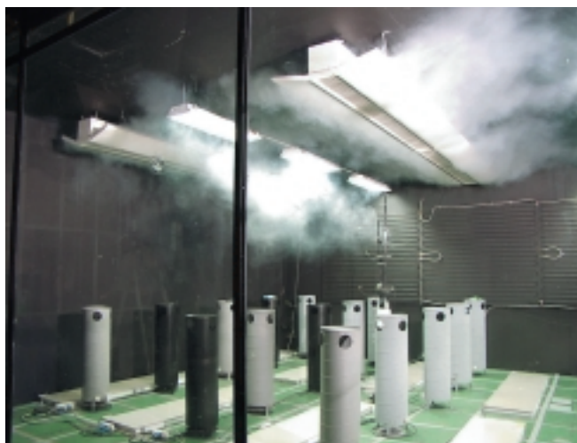
Bild 20: Strömungsverlauf und Raumluftgeschwindigkeiten beim Deckenkühlkonvektor mit einseitigem Luftaustritt
