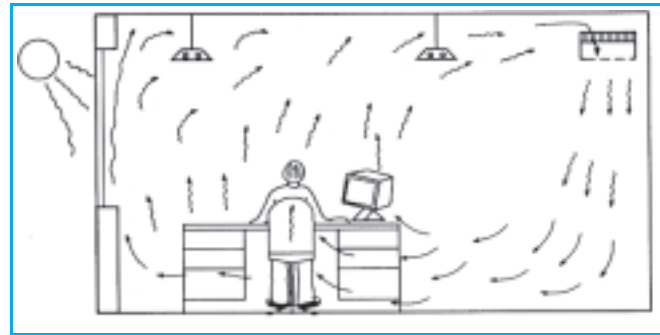
Bild 10: Deckenkühlkonvektor an oder nahe der Flurwand
