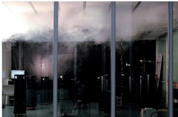
Bild 8: Stellung Kühlfall, Zulufttemperatur 16 bis 21 °C
