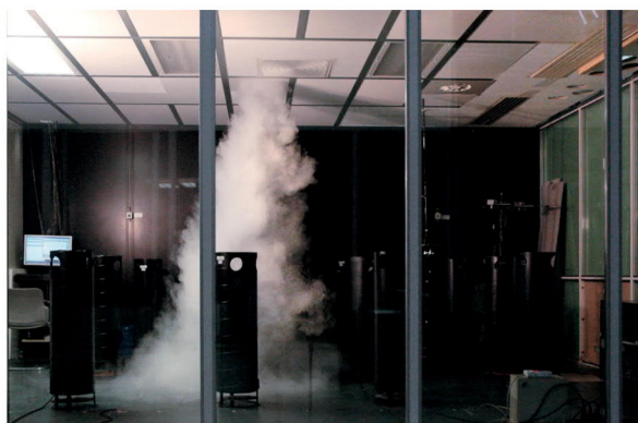
Bild 10: Stellung Aufheiz-Fall, Zulufttemperatur 27 bis 30 °C
