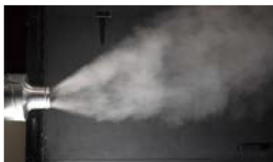
Bild 6b: Klappenwinkel 45° zur Horizontalen
