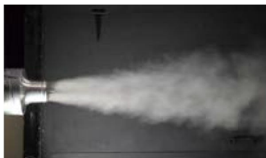
Bild 6a: Klappenwinkel 0° zur Horizontalen
