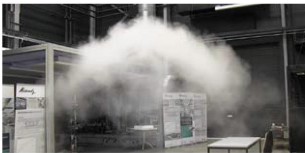
Bild 1: Strömungsbild mittels Rauch sichtbar gemacht; Verdrängungs-Misch-Strömung
