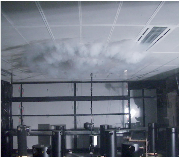
Bild 6: Luftstrahlausbildung beim Puri-Drall und Puri-Clean
