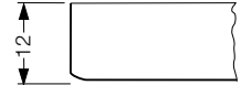
Detail Z Typ Q1 und Q2 – quadratische Sichtfläche 90°-Umkantung für Einbau in Kassettendecken
