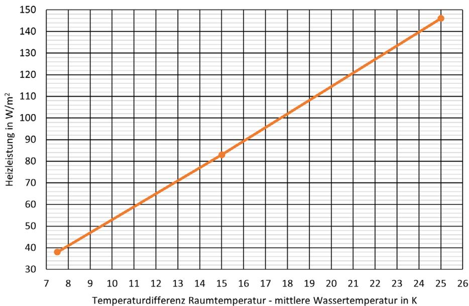
Heizleistung ohne rückseitiger Wärme-Akustikdämmung
