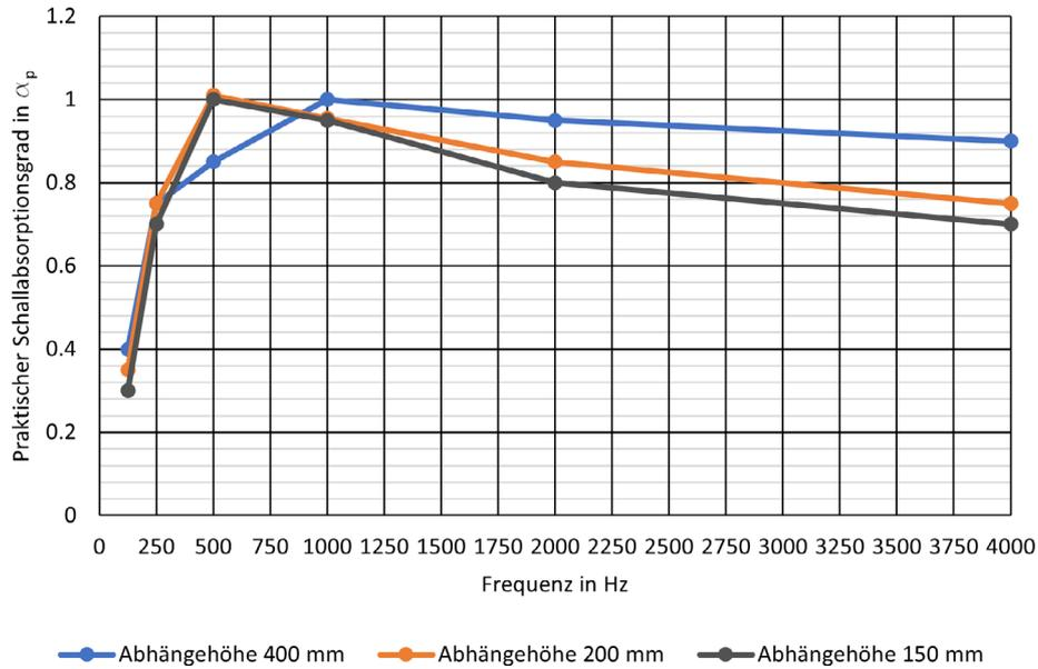
mit Akustikdämmung Top Phon, Messung nach ISO 11654
