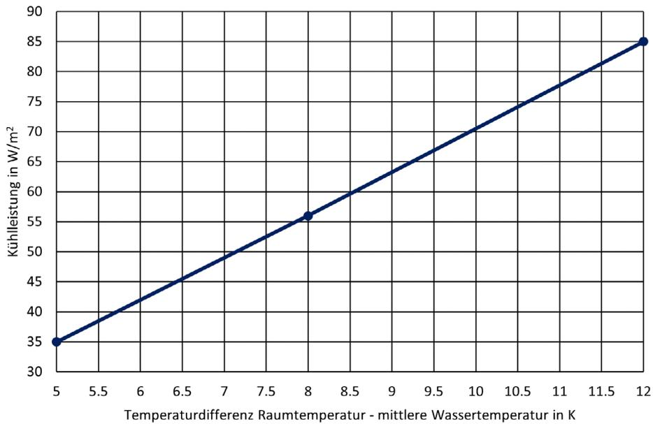
Kühlleistung ohne rückseitiger Wärme-Akustikdämmung
