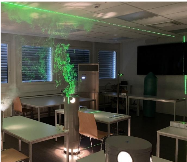
Thermik des Dummies (Person) ist höher als Raumlft-Strömung
